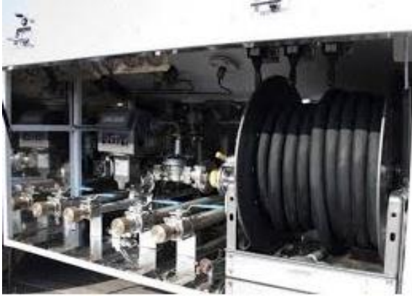
الشاحنة الصهرجية لنقل المخلفات السائلة والزيوت، مزودة بنظام خرطوم ومواتير سحب ودفع حتى تكون العملية مغلقة تماما.
