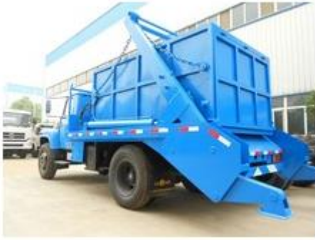
شاحنة نقل الحمأة حيث تعبأ الحمأة في صندوق مغلق تماما عن طريق المضخة الدوارة وتوضع بواسطة رافعه (ونش) على الشاحنة.
