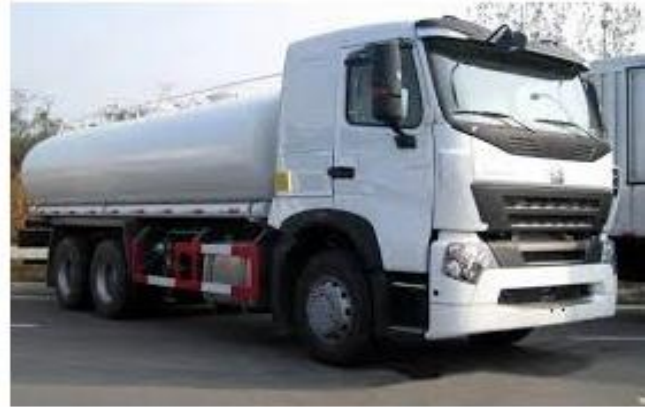
الشاحنة الصهرجية لنقل المخلفات السائلة والزيوت، مزودة بنظام خرطوم ومواتير سحب ودفع حتى تكون العملية مغلقة تماما.
