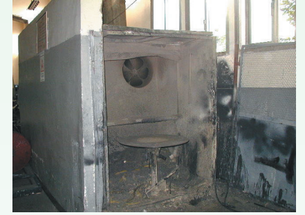
شكل رقم (١) غرفة الرش اليدوي التي تم استبدالها بمعدات الرش الأوتوماتيكي
