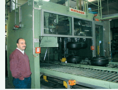
شكل رقم (٢) ماكينة الرش الجديدة تقوم بإداء العملية أوتوماتيكياً
