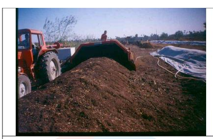
ماكينة تقليب مزودة بجهاز للترطيب تتتج سماد متجانس من الكومبوست
